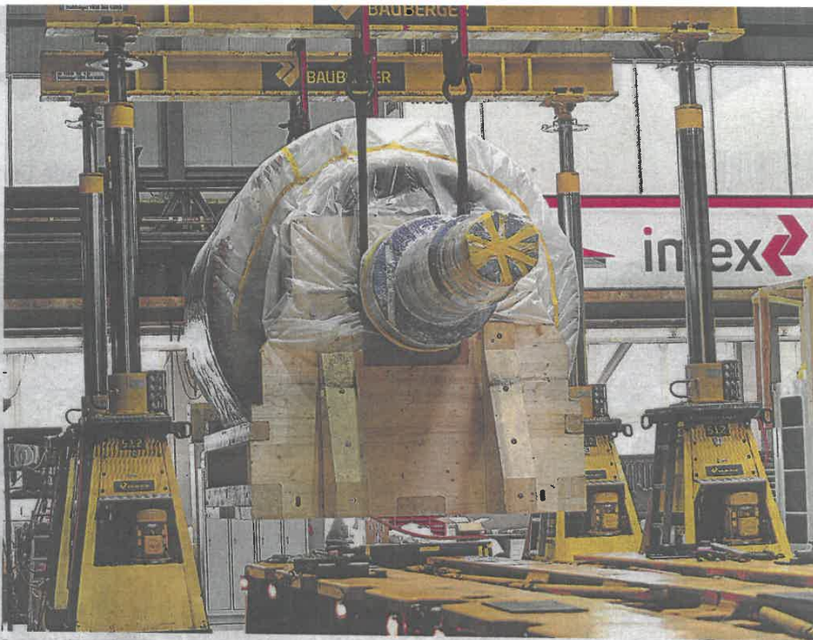
Der Rotor ist rund 90 Tonnen schwer.
