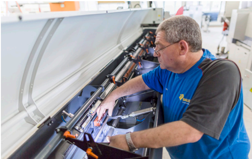
Ausrichtung des Stangenladers zum Langdreher, wo Werkzeuge aus Stäben von 4000 mm Länge hergestellt werden.
