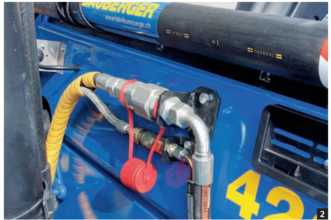
Die Hydraulik-Schnellkupplungen wurden für das rasche Wechseln der Masten an der Stirnwand des Gas-Gabelstaplers Hyster S7.0FT Advance angebracht.
