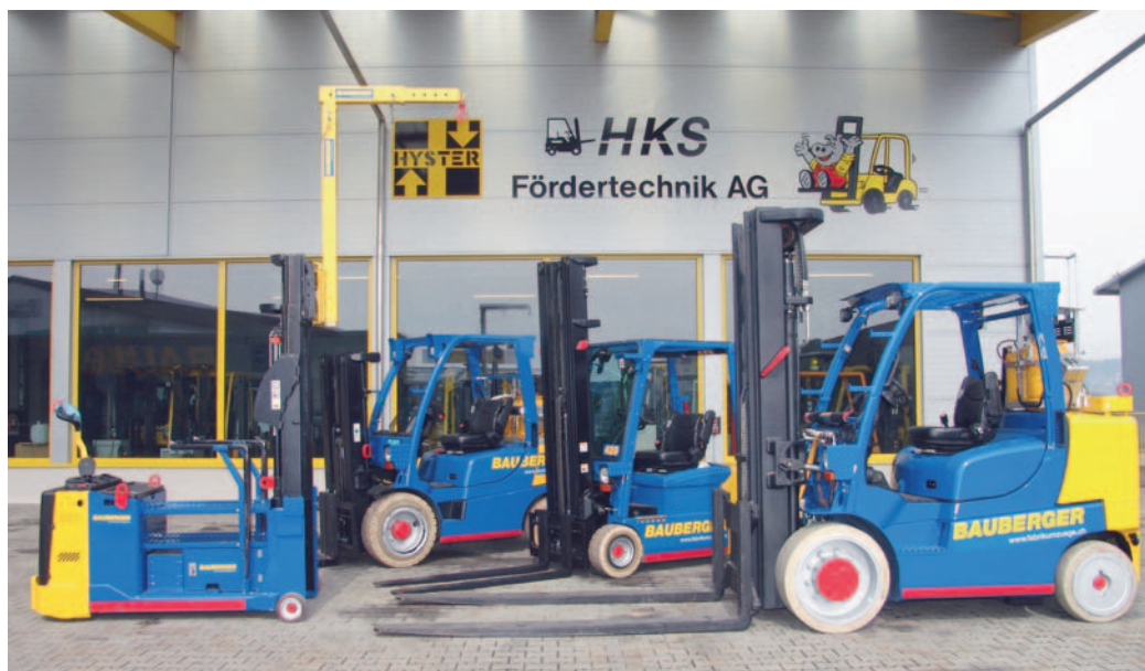
Die vier Gabelstapler in den typischen Bauberger-Farben (v. l. n. r.): Elektro Deichsel-Gegengewichtstapler Hyster S1.5C, Gas-Gabelstapler Hyster H3.5FT Advance+, Elektro-Gabelstapler Hyster J2.00XMT ACX und der Gas-Gabelstapler Hyster S7.0FT Advance.
